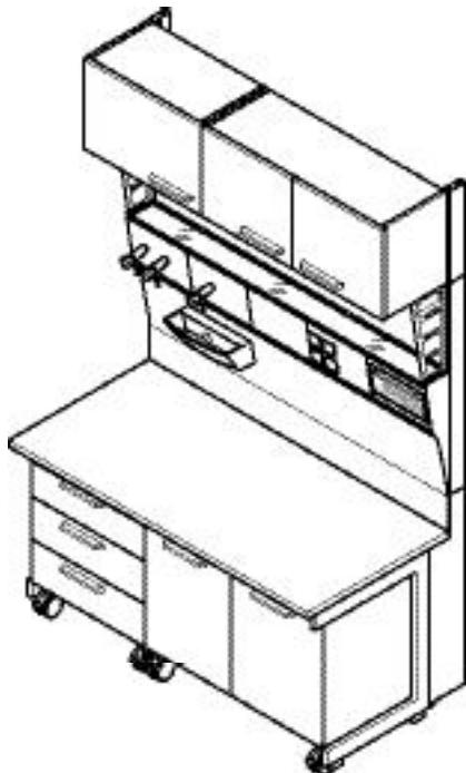
Сервисная стойка для островного стола с подкатными тумбами, на цоколе и подводом коммуникаций сверху, рабочая высота 900 мм
