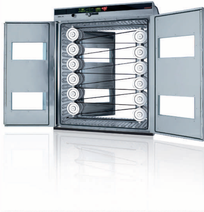
Поточная линия в проходных сушильных шкафах (вход и выход конвейерной ленты по сторонам)
