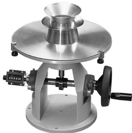
**Столик для испытания на растекаемость**
